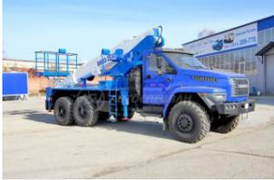
Автогидроподъемник ВИПО-28-01 на шасси Урал NEXT 4320-6952-72 6x6, 275 л.с., ЯМЗ-53623-10, КПП ЯМЗ-1105, 5 ст., ДОМ, ДЗК, Евро 5. Высота подъема 28 метров
