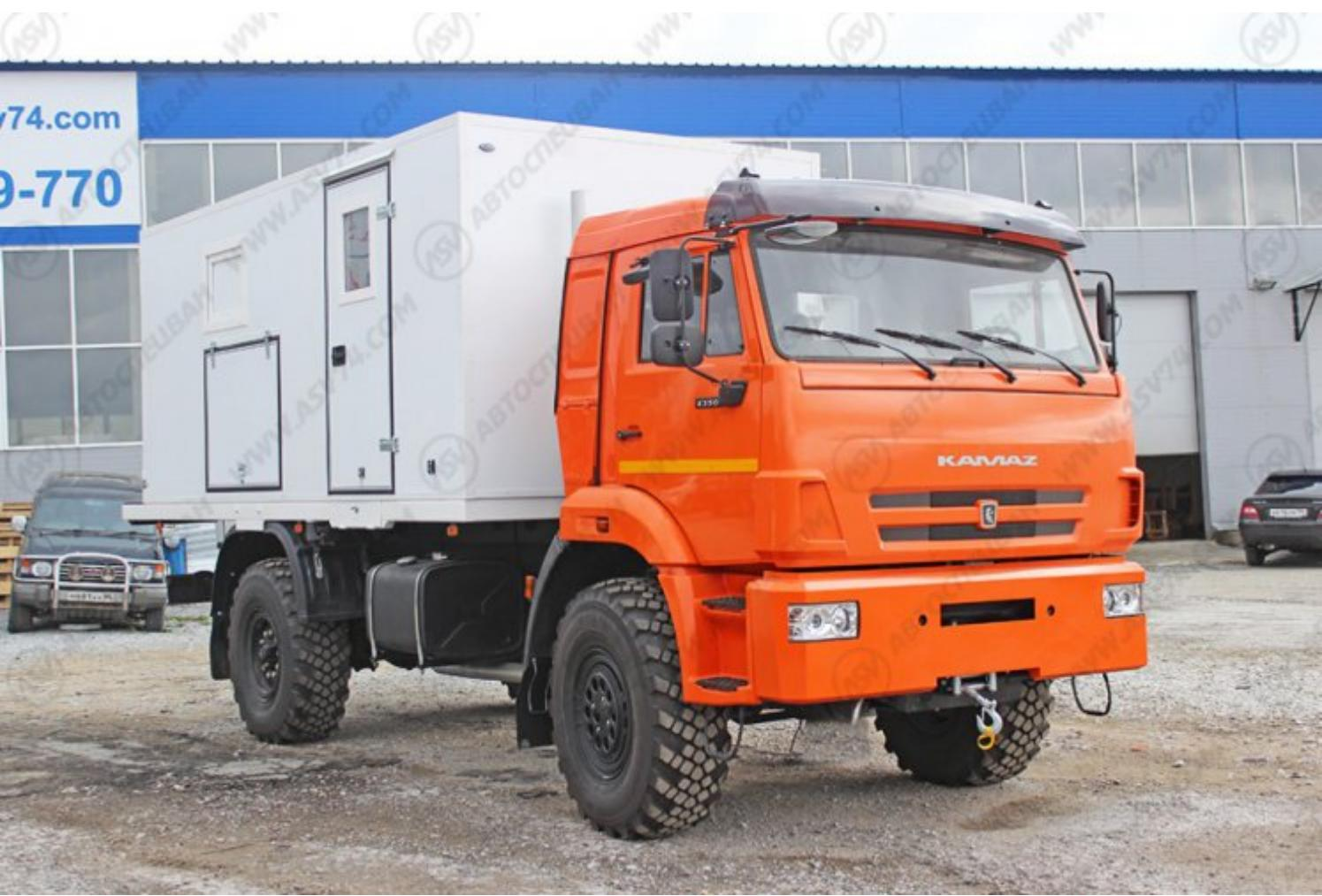
Лаборатория передвижная – представляет собой изотермический фургон смонтированный на шасси автомобиля КАМАЗ 43502 и предназначена для размещения и транспортирования грузов, приборов и
