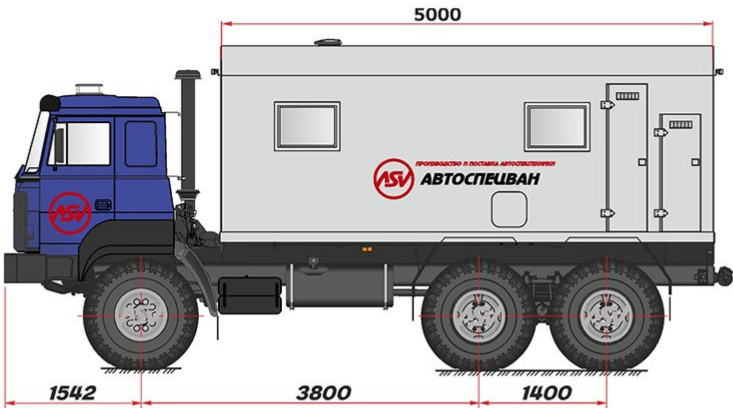
Фургон изотермический S=60мм.
