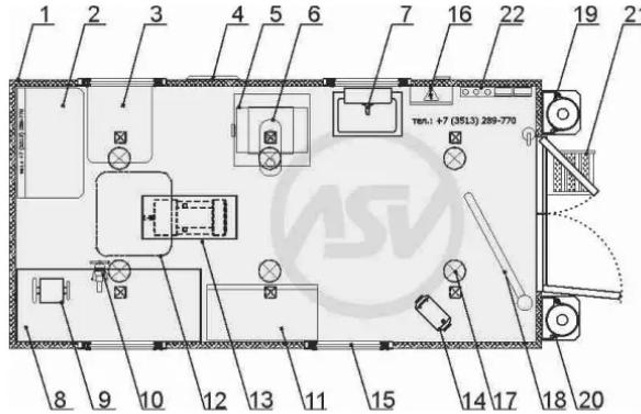
Фургон изотермический S=60мм.
