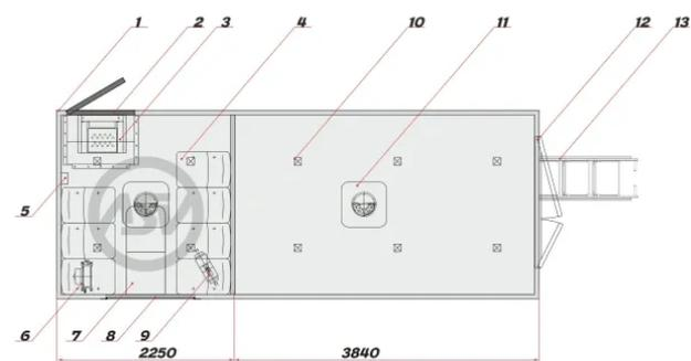
1. Кузов-фургон из сэндвич-панелей  $S=60\text{мм}$ .
