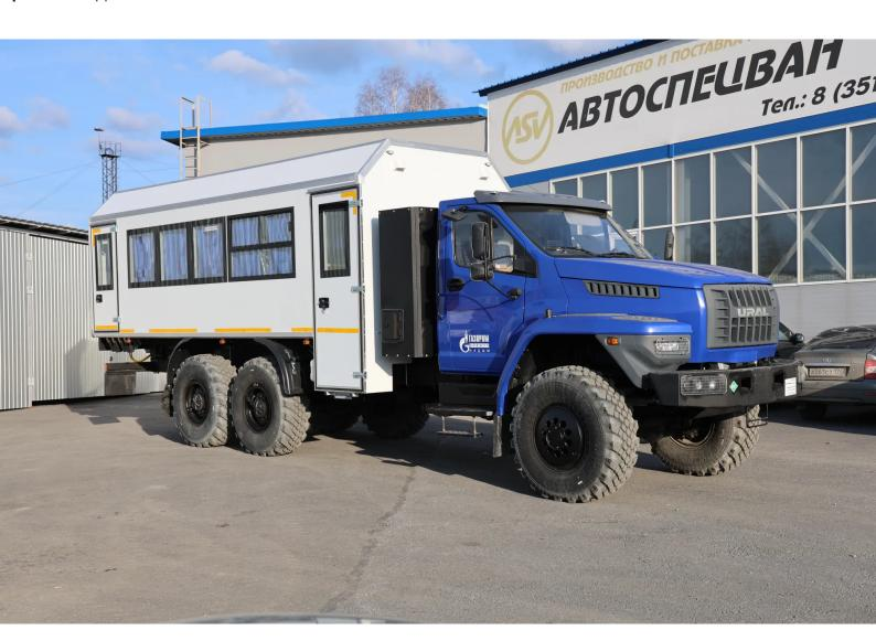
Кузов-фургон представляет собой конструкцию из пятислойных «сэндвич-панелей». Снаружи и изнутри фургон обшит стальным
