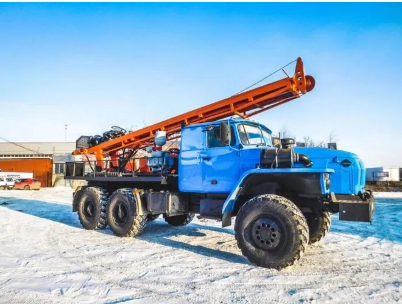
"УРБ 2ДЗ" способна бурить вращательным способом с промывкой, продувкой, ударно-вращательным способом погружным пневмоударником и шнеками скважин различного назначения, в том числе водозаборных. Перемещающийся по мачте вращатель с гидравлическим приводом совместно со специальным элеватором используется для свинчивания и развинчивания бурильных труб и
