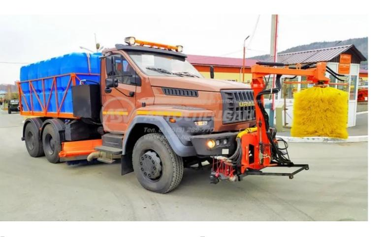
Емкость для воды и реагентов на раму шасси. Пластиковые емкости, суммарный объем пластиковых емкостей 10 м3.
