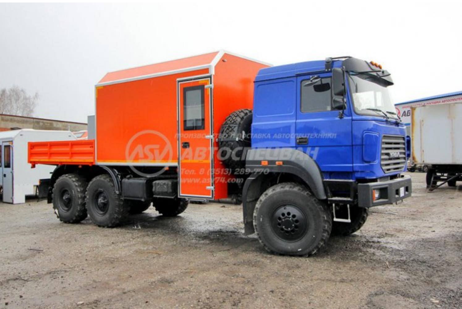
Кузов-фургон АСВ7721 представляет собой конструкцию из пятислойных «сэндвич-панелей». Снаружи и изнутри фургон обшит стальным оцинкованным листом с полимерным лакокрасочным покрытием («плакированный лист»). Пространство между внешней и внутренней
