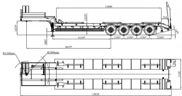
\*Размеры при полной массе полуприцепа
