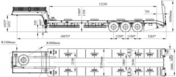
\*Размеры при полной массе полуприцепа
