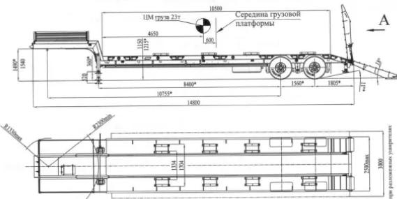
\*Размеры при полной массе полуприцепа
