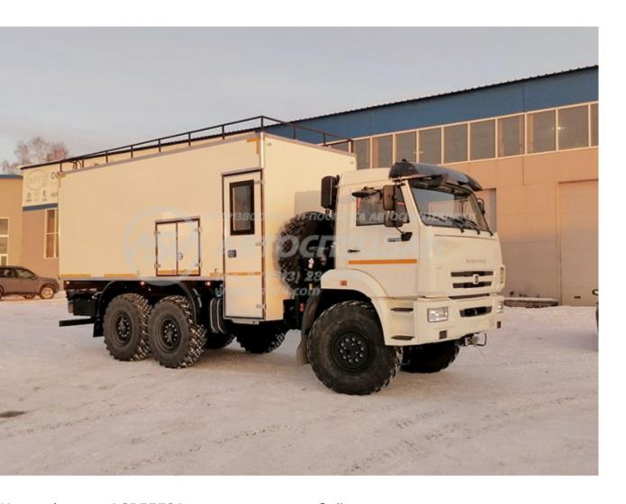
Кузов-фургон АСВ77721 представляет собой конструкцию из пятислойных «сэндвич-панелей». Снаружи и изнутри фургон обшит стальным оцинкованным листом с полимерным лакокрасочным
