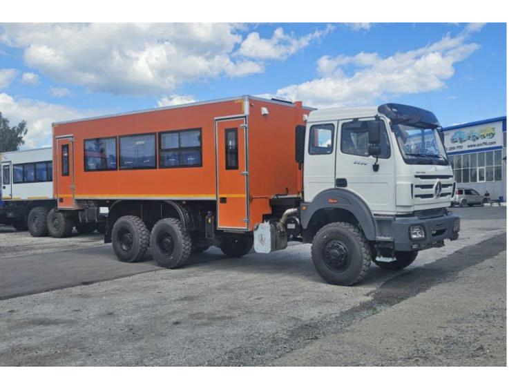
**Кузов-фургон** представляет собой конструкцию из пятислойных «сэндвич-панелей». Снаружи и изнутри фургон обшит стальным оцинкованным листом с полимерным лакокрасочным покрытием («плакированный лист»). Пространство между внешней и внутренней
