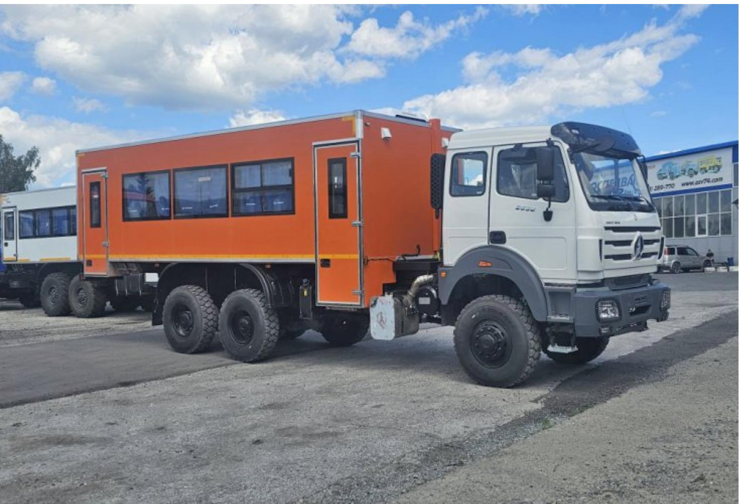
**Кузов-фургон** представляет собой конструкцию из пятислойных «сэндвич-панелей». Снаружи и изнутри фургон обшит стальным оцинкованным листом с полимерным лакокрасочным покрытием («плакированный лист»). Пространство между внешней и внутренней
