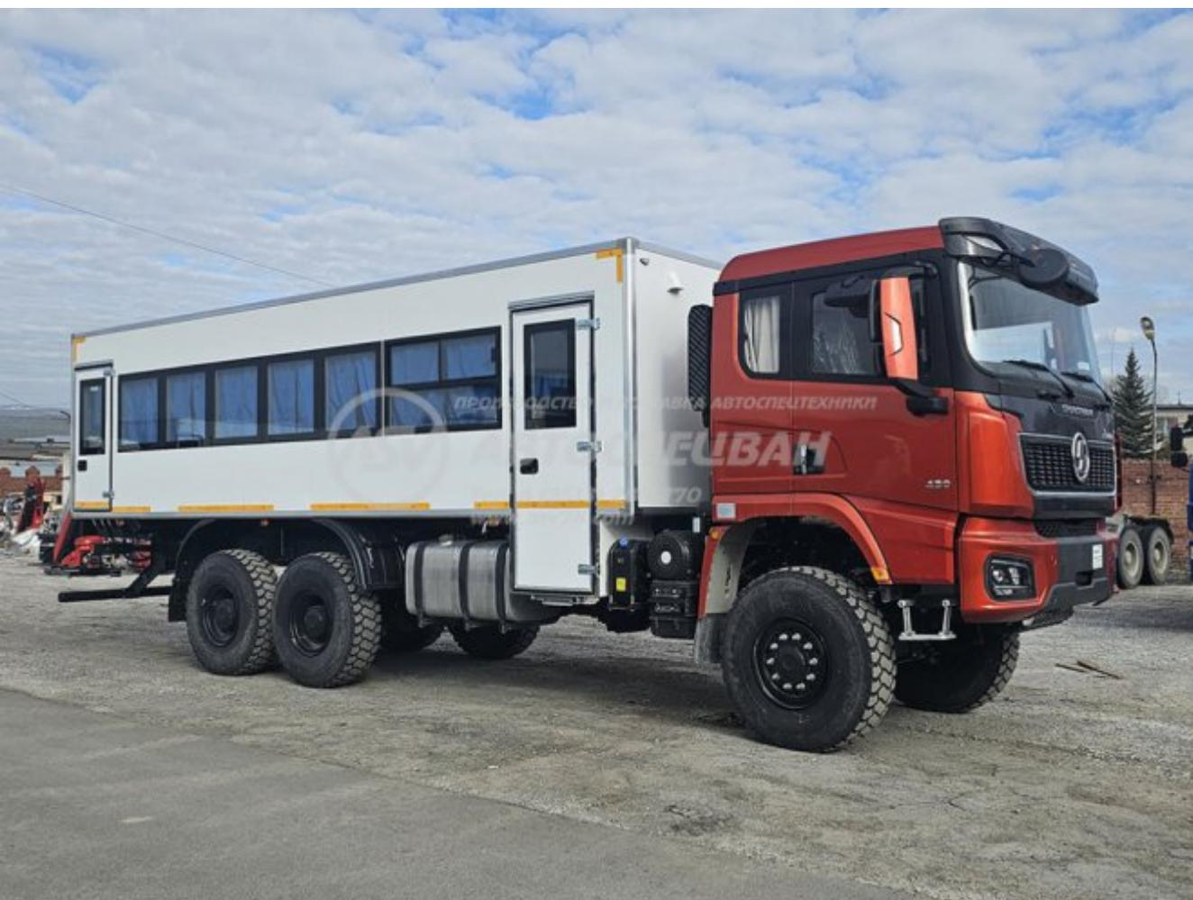
**Кузов-фургон** представляет собой конструкцию из пятислойных «сэндвич-панелей». Снаружи и изнутри фургон обшит стальным оцинкованным листом с полимерным лакокрасочным покрытием
