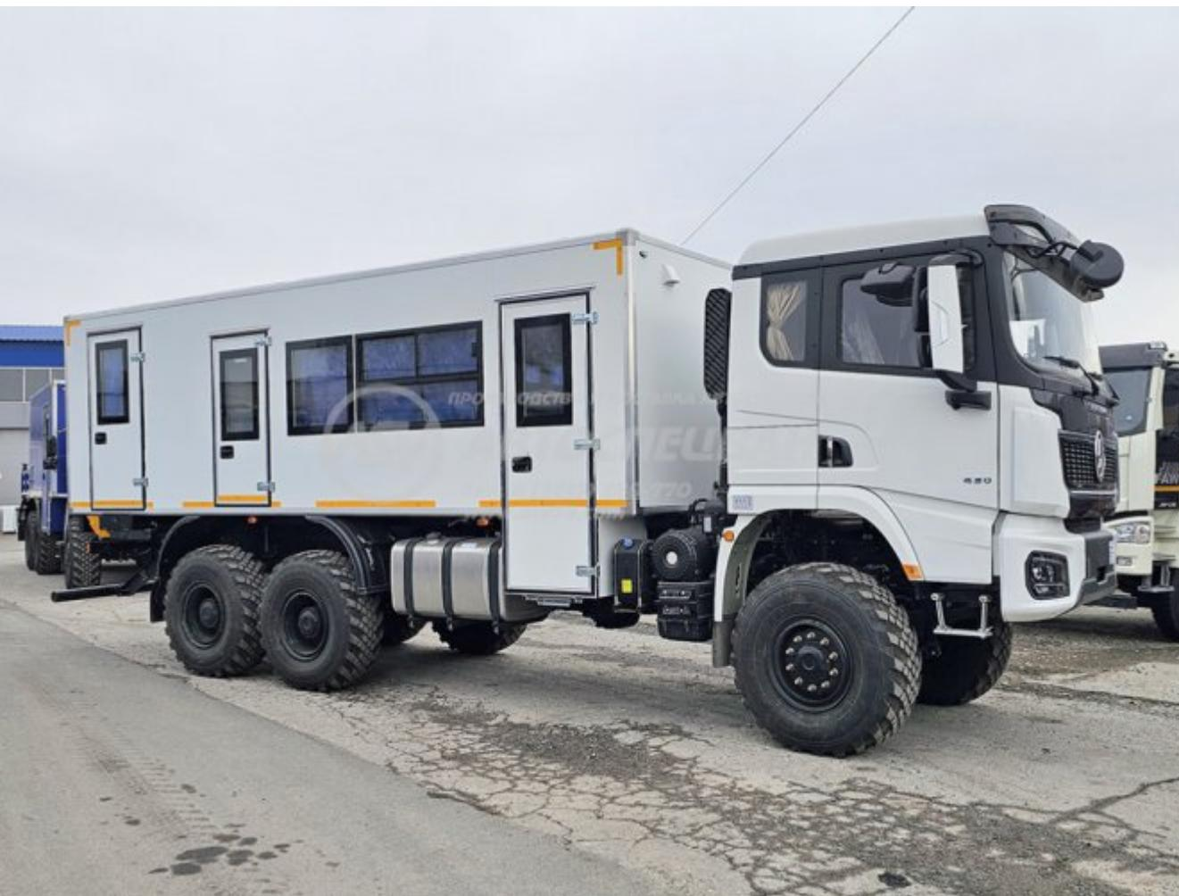
**Кузов-фургон** представляет собой конструкцию из пятислойных «сэндвич-панелей». Снаружи и изнутри фургон обшит стальным оцинкованным листом с полимерным лакокрасочным покрытием
