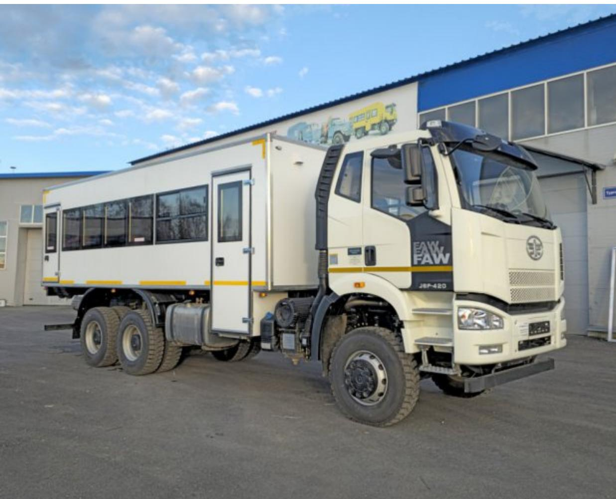
**Кузов-фургон** представляет собой конструкцию из пятислойных «сэндвич-панелей». Снаружи и изнутри фургон обшит стальным оцинкованным листом с полимерным лакокрасочным покрытием («плакированный лист»). Пространство между внешней и внутренней
