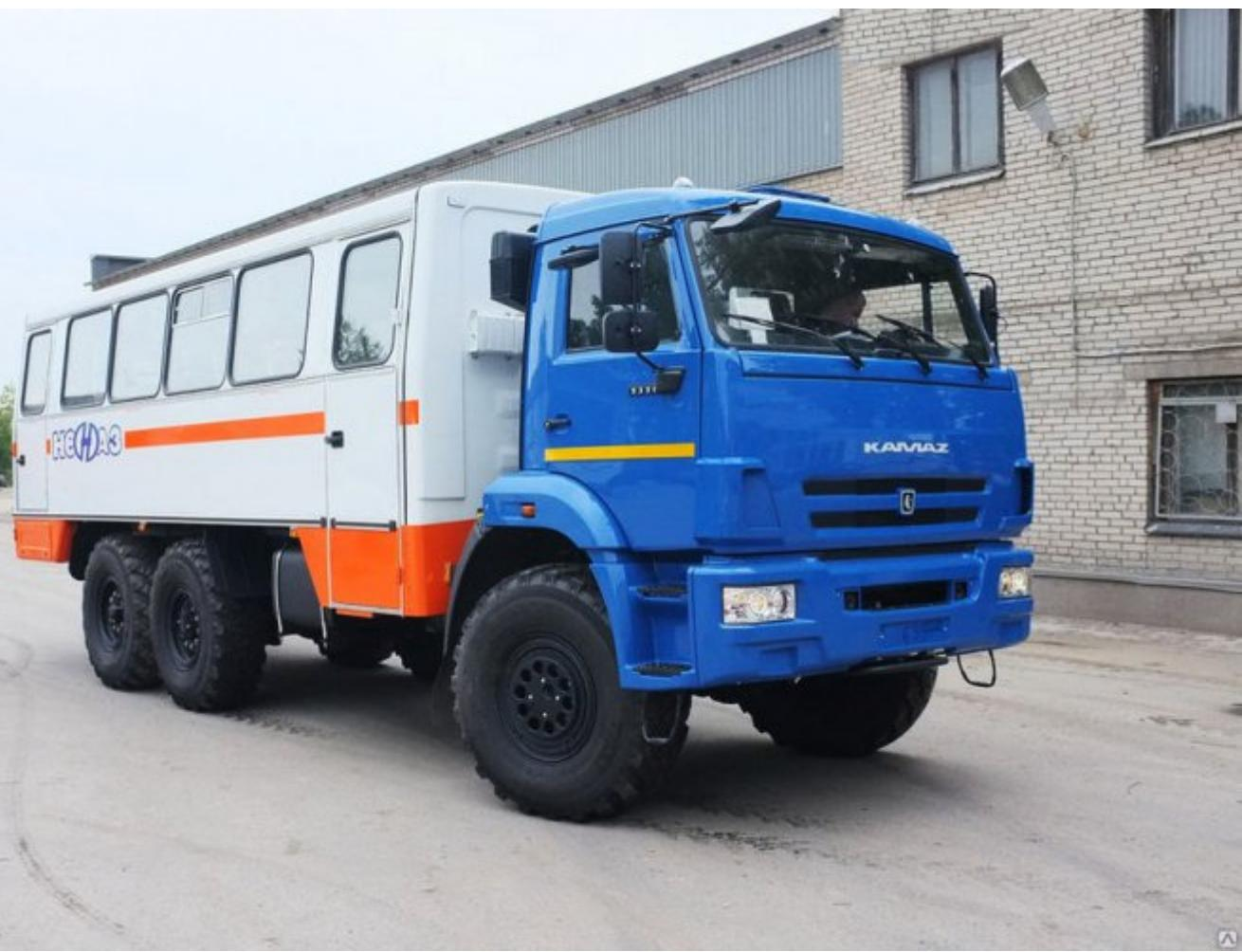
Кузов закрытый фургонного типа, каркасной конструкции с термоизоляцией, в правой боковине снабжен двумя дверями, одна из них аварийная; запасное колесо установлено на задней стенке с внешней
