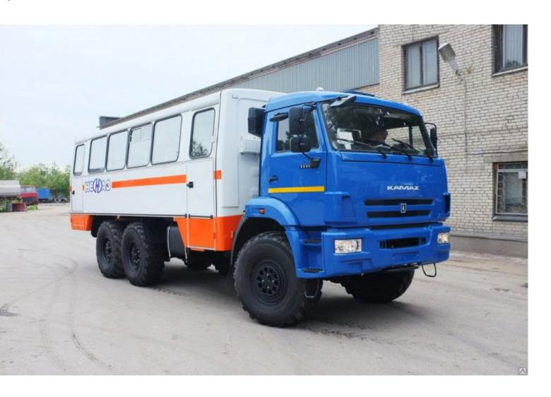
Кузов закрытый фургонного типа, каркасной конструкции с термоизоляцией, в правой боковине снабжен двумя дверями, одна из них аварийная; запасное колесо установлено на задней стенке с внешней
