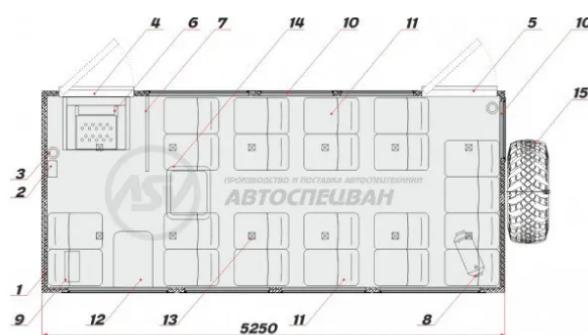
Кузов-фургон изотермический S=60 мм ;
