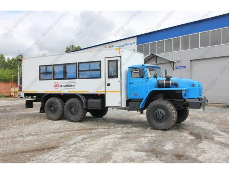
Кузов-фургон представляет собой конструкцию из пятислойных «сэндвич-панелей». Снаружи и изнутри фургон обшит стальным оцинкованным листом с полимерным лакокрасочным покрытием
