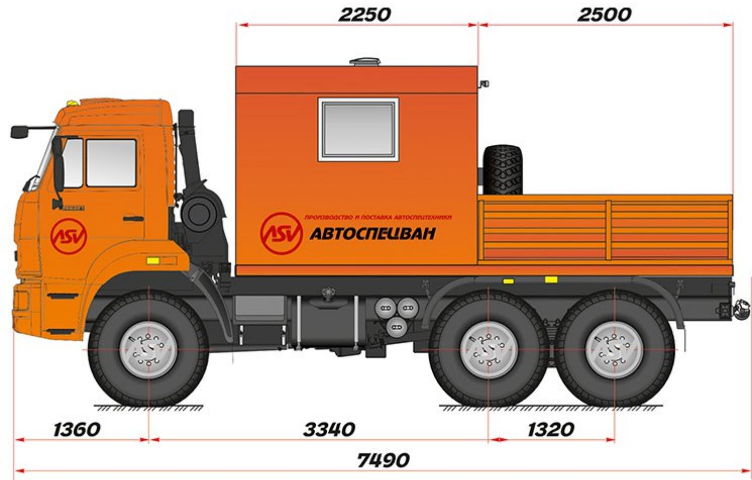
ГПА предназначена для доставки бригады, размещения и транспортирования оборудования (используемого для ремонта и обслуживания технических средств), обеспечения координации действий
