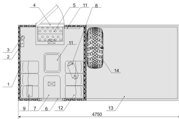
Кузов-фургон изотермический S=60 мм ;
