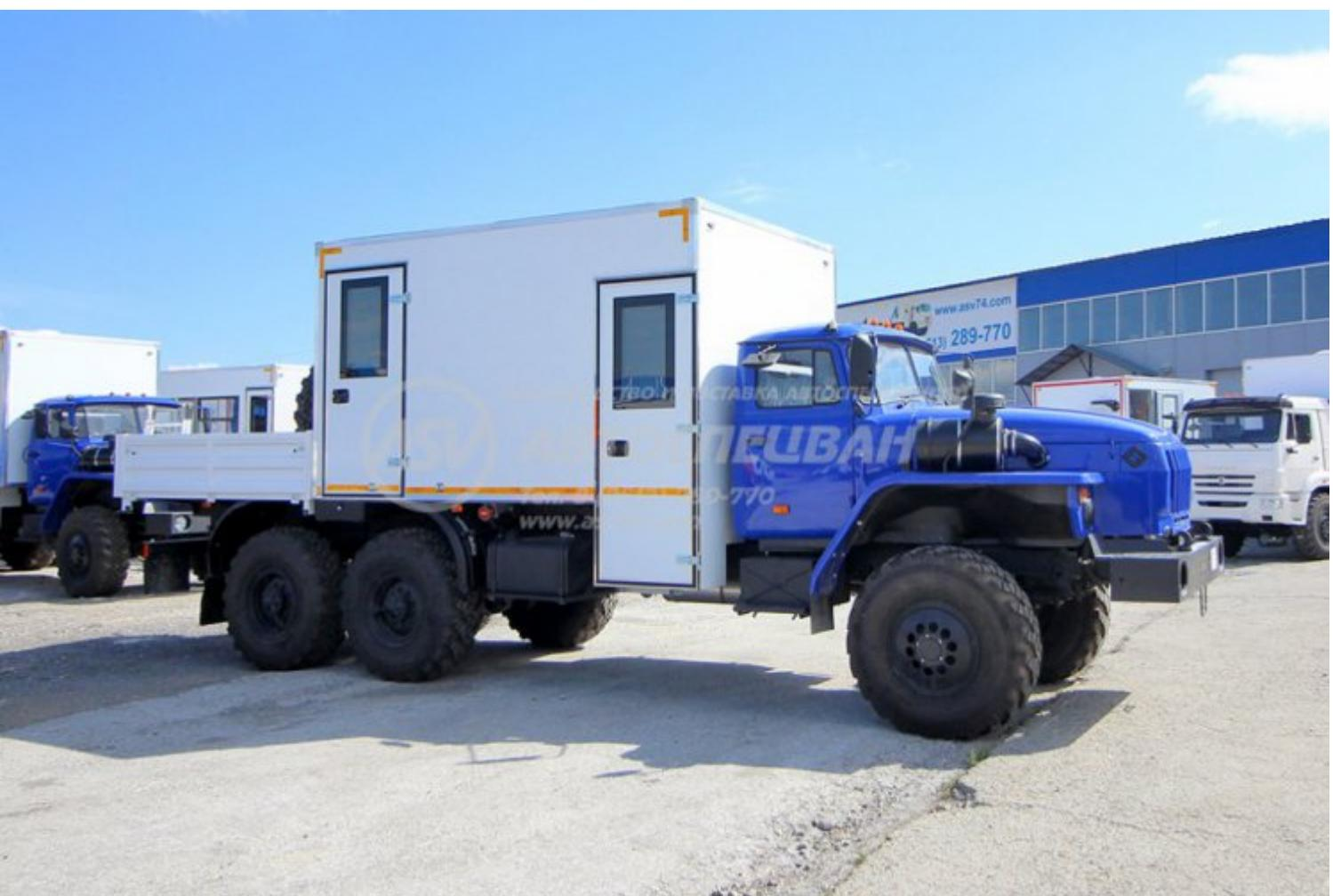
Кузов-фургон АСВ7721 представляет собой конструкцию из пятислойных «сэндвич-панелей». Снаружи и изнутри фургон обшит стальным оцинкованным листом с полимерным лакокрасочным покрытием
