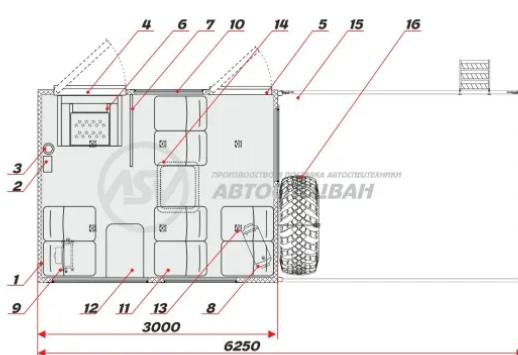
Кузов-фургон изотермический S=60 мм ;
