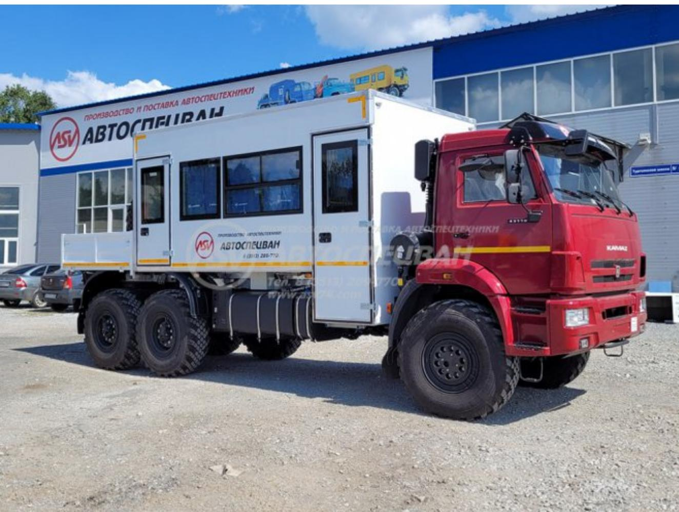
Кузов-фургон представляет собой конструкцию из пятислойных «сэндвич-панелей». Снаружи и изнутри фургон обшит стальным оцинкованным листом с
