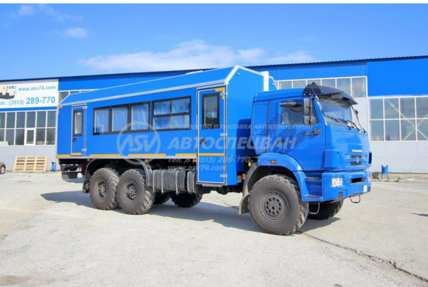
Кузов-фургон представляет собой конструкцию бескаркасного типа.
