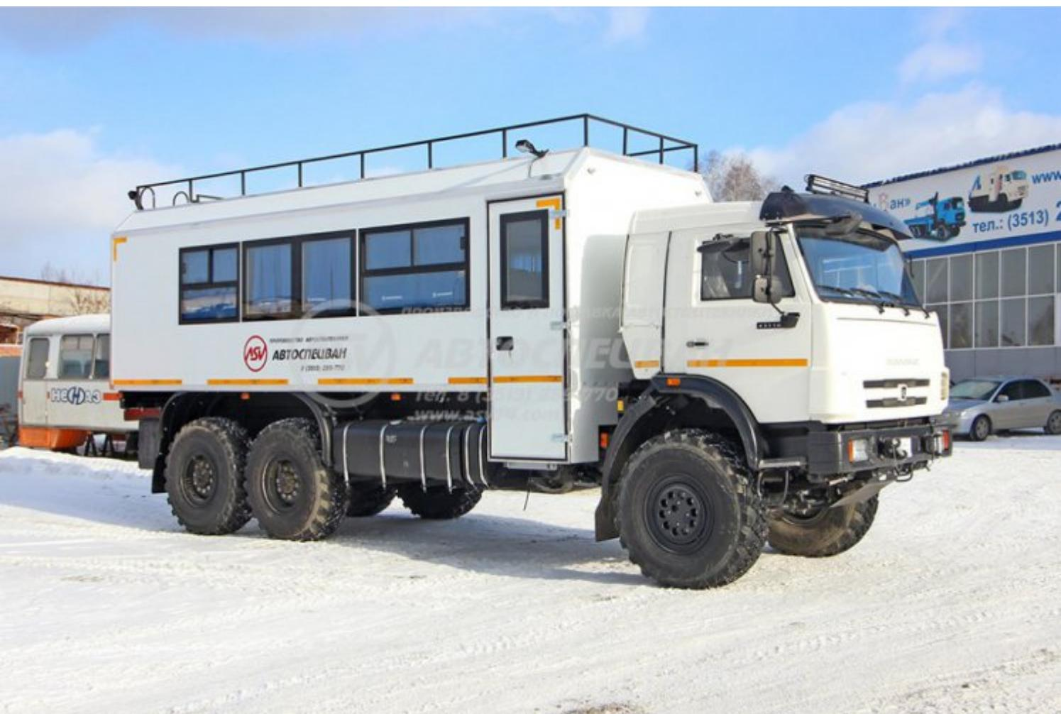
1. Кузов-фургон представляет собой конструкцию из пятислойных «сэндвич-панелей». Снаружи и изнутри фургон обшит стальным оцинкованным листом с полимерным лакокрасочным покрытием
