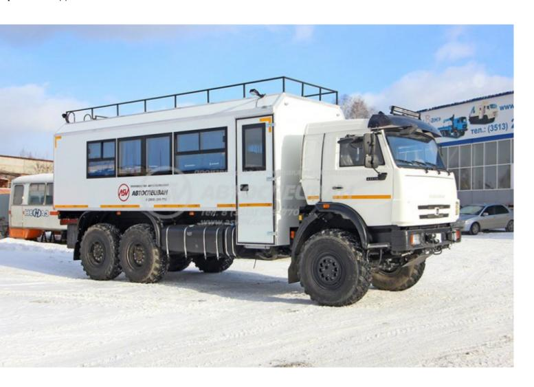
1. Кузов-фургон представляет собой конструкцию из пятислойных «сэндвич-панелей». Снаружи и изнутри фургон обшит стальным оцинкованным листом с полимерным лакокрасочным покрытием
