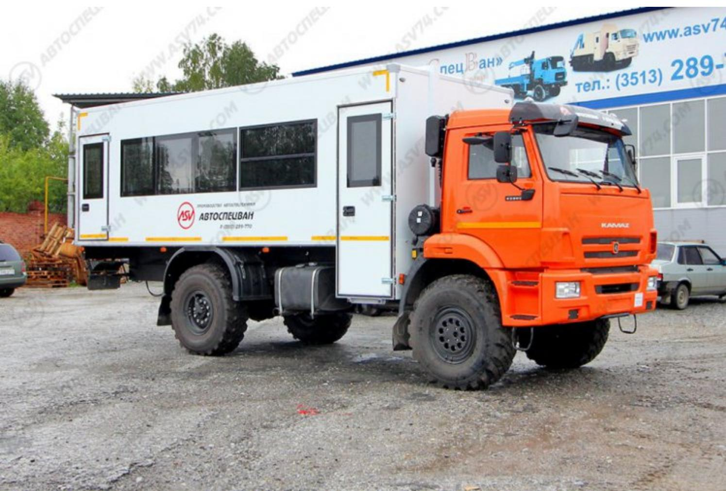
Кузов-фургон представляет собой конструкцию из пятислойных «сэндвич-панелей». Снаружи и изнутри фургон обшит стальным оцинкованным листом с полимерным лакокрасочным покрытием
