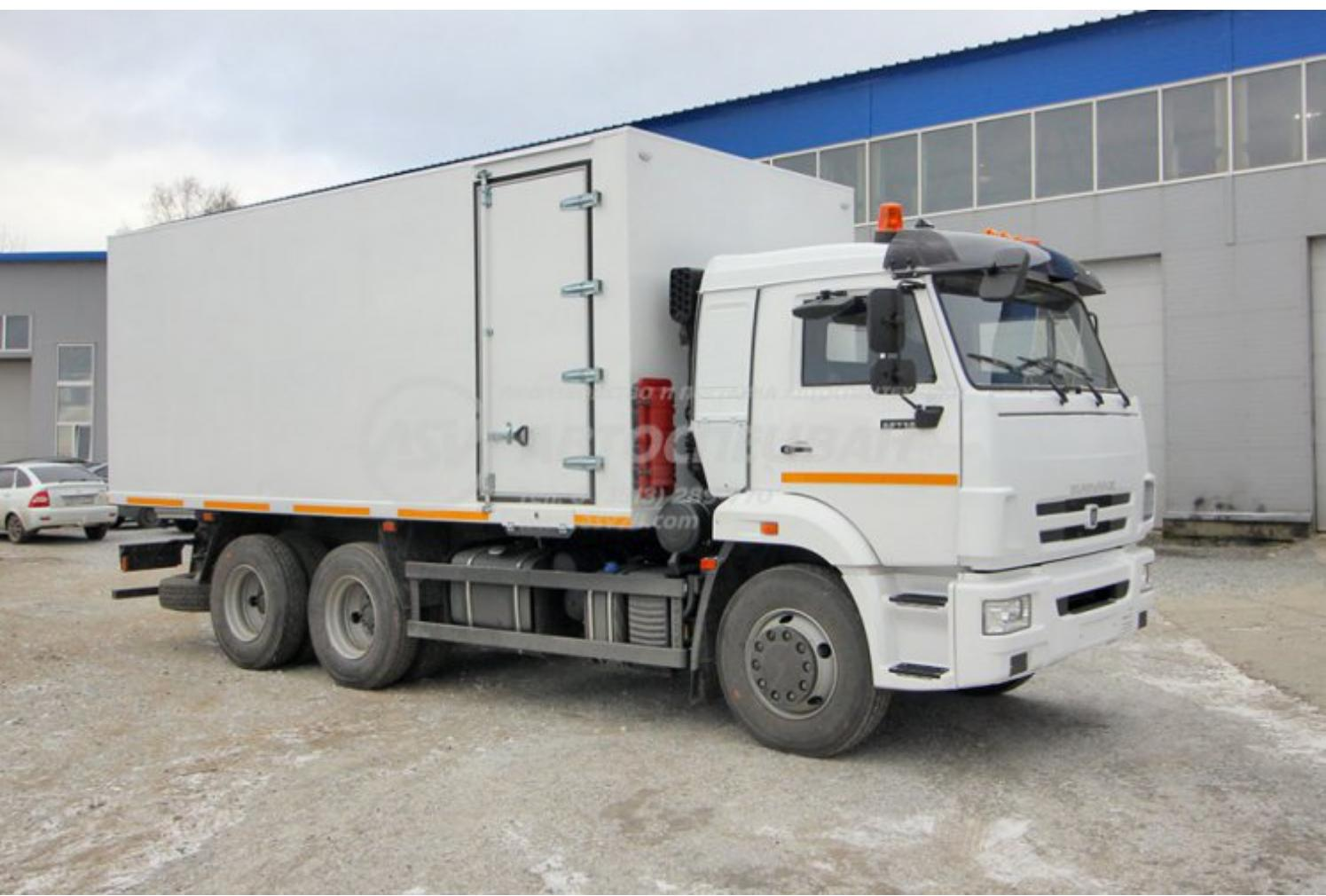
Кузов-фургон: сварной, каркасно - металлический из профильной трубы; наружная обшивка - стальной лист 1,5 мм; утеплитель - пенополистирол (S=60 мм). Внутренняя отделка: фанера обработанная специальным негорючим составом; пол - фанера бакелитовая (12 мм), пенополистирол (30 мм), фанера (12 мм), рифлённый алюминиевый лист 3 мм., цвет
