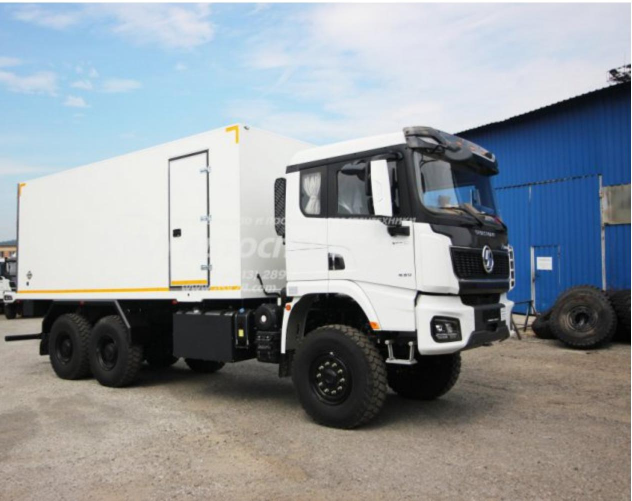
Кузов-фургон: наружная обшивка – стальной лист, утеплитель - пенополистирол (S=60) специальным негорючим составом; пол – фанера бакелитовая (12 мм), пенополистирол 40 мм., цвет фургона белый.
