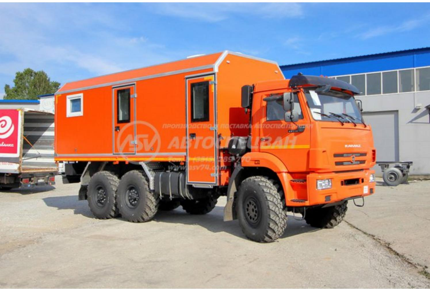
**Кузов-фургон бескаркасный**, выполнен из сэндвич – панелей толщиной 60мм. Панели КФ усилены оцинкованным листом с полимерным покрытием. В правой панели расположена одностворчатая дверь. В задней части КФ находится двухстворчатая дверь с замком и
