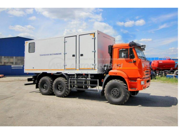
Кузов фургон бескаркасный, выполнен по бескаркасной технологии из пятислойных сэндвич-панелей толщиной 60 мм, изготовленных методом вакуумного формования. Панели МП снаружи защищены снаружи с двух сторон оцинкованным листом с полимерным покрытием (плакированным
