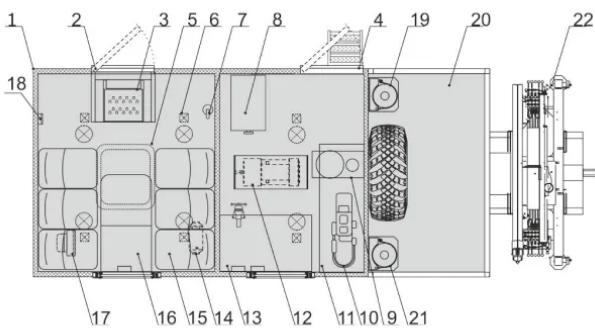
Кузов фургон изотермический S=60мм.
