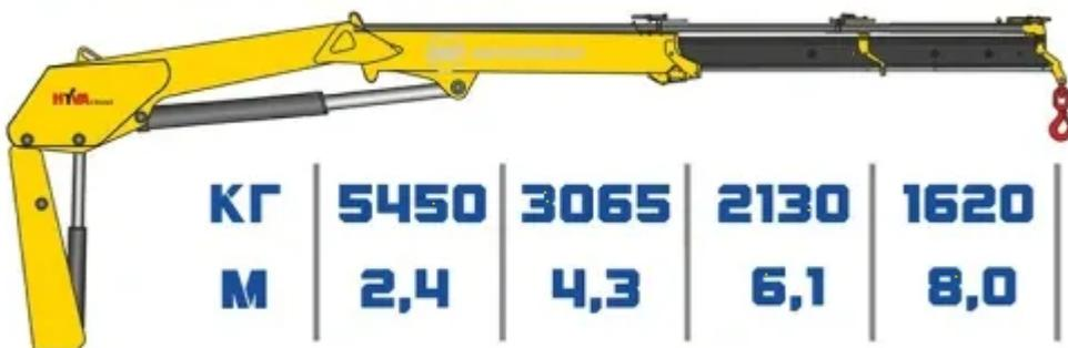
Hyva Crane модель HB150E2 – успешно зарекомендовал себя как простой, не дорогой и надежный партнер. Опции установки включают в себя ручные поворотные опоры, гидравлическую систему защиты от перегрузки, бак на 100л, угол поворота 380 град., систему EES (при выдвигании стрелы специальный регенеративный клапан повторно использует гидравлическое масло и обеспечивает высокую скорость работы, не уменьшая безопасность крана).
