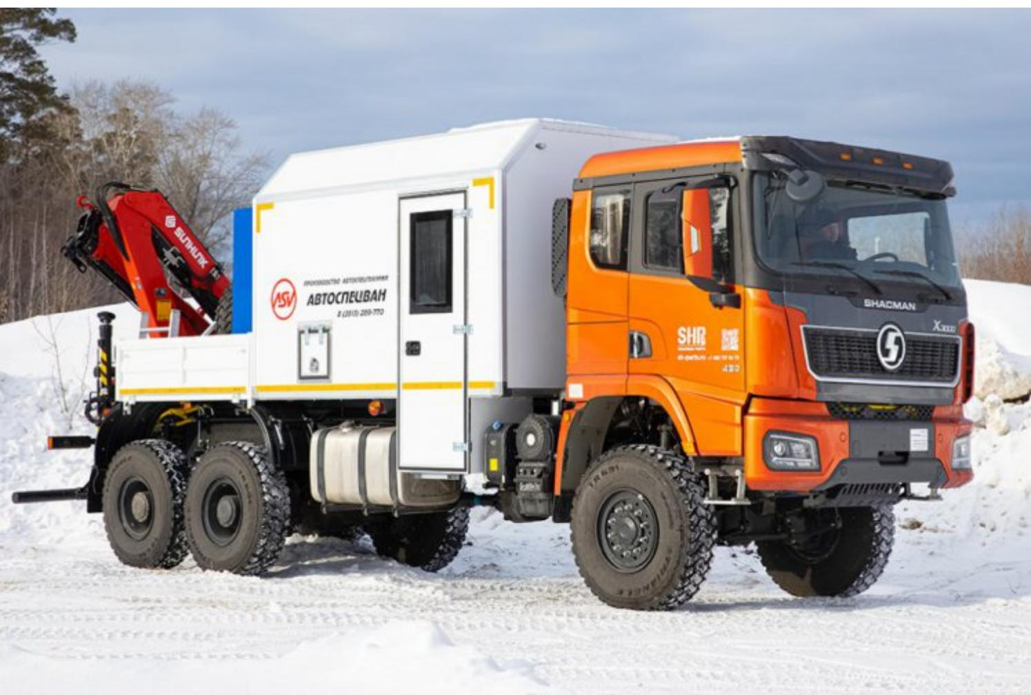
Кузов-фургон ACB7721 представляет собой конструкцию из пятислойных «сэндвич-панелей». Снаружи и изнутри фургон обшит стальным оцинкованным листом с полимерным лакокрасочным покрытием
