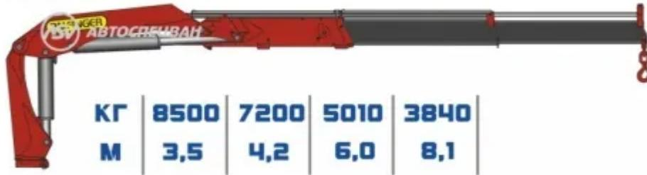
INMAN IM 320 является самой грузоподъемной КМУ ИНМАН, предназначенной для монтажа на автомобильные шасси Урал, Камаз. Число секций телескопирования может быть от 2 до 5 шт., грузовой момент достигает 30,4 тм, максимальная г/п до 8,5 т, а гидравлический вылет стрелы до 14 м.
