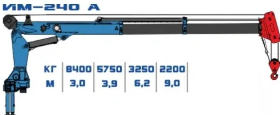
Краноманипуляторная установка с тросовой подвеской крюка, за счет которой возможна работа с грузами ниже уровня земли, либо из-за препятствий (стены, заборы). В отличие от обычного манипулятора, ИМ 240А с тросовой подвеской крюка позволяет поднимать и опускать груз плавно и строго по вертикали, что обеспечивает более точное позиционирование груза.
