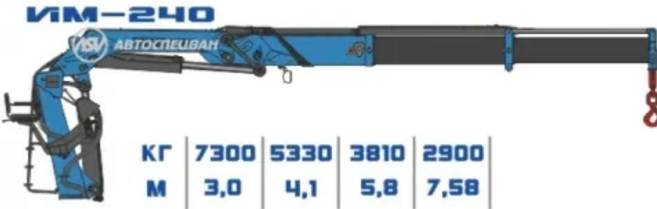
Краноманипуляторная установка максимальной грузоподъемности, среди манипуляторов Z-образного складывания, производимых ЗАО "ИНМАН". Имеет от одной до четырех секций гидравлического телескопирования. При использовании гуська возможно увеличение вылета до 18 м. Также возможна работа с люлькой, бурильным оборудованием и грейфером
