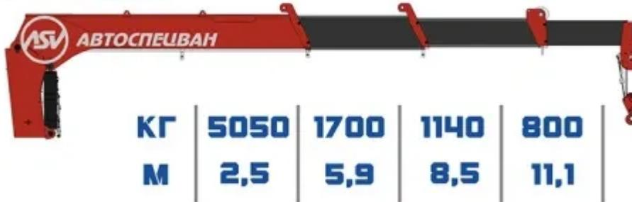
INMAN IT 120 новый тросовый кран-манипулятор в сегменте 5-ти тонных КМУ. Кран-манипулятор имеет 3 гидравлически выдвигающиеся секции, что обеспечивает один из самых больших вылетов в своем классе – 11,1 м. Новая система выдвижения аутригеров с регулирующими роликами обеспечивает легкость ручного выдвижения балок. Длина каната лебедки составляет 75 метров. INMAN IT 120 обладает качественной окраской, а также всеми необходимыми датчиками и приборами безопасности.
