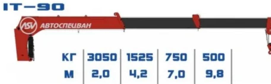
Тросовый кран-манипулятор PALFINGER INMAN IT 90 – новый «трехтонник» отечественного производства, который создан для того, чтобы стать выгодным и незаменимым помощником малому бизнесу, эксплуатирующему данную технику в строительстве и погрузо-разгрузочных работах. Максимальный вылет стрелы для данной модели может достигать 12,7 м (для исполнения с тремя секциями телескопирования). В таблице указаны характеристики базового исполнения с двумя секциями.
