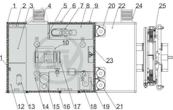
1. Кузов фургон изотермический S=60мм.
