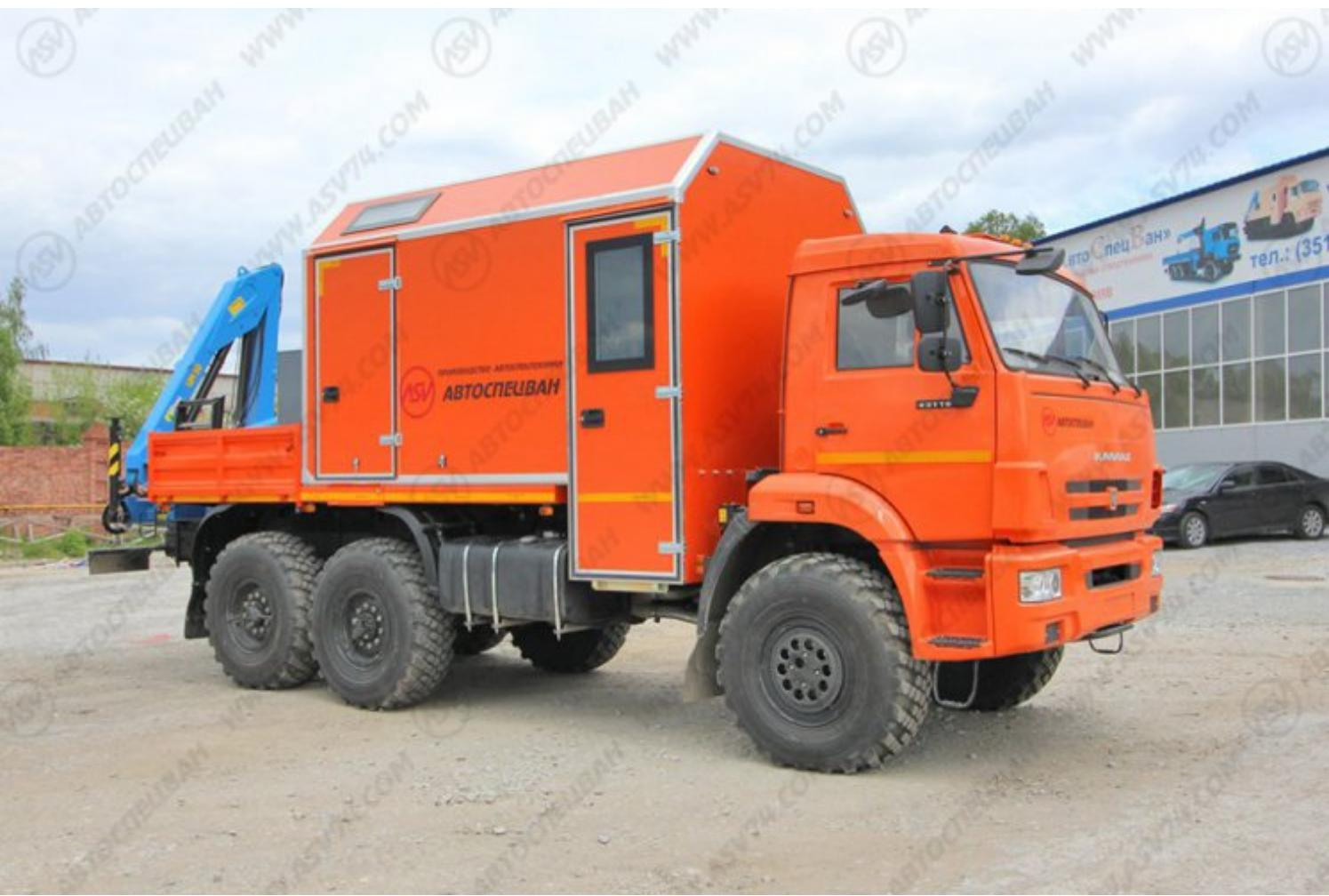
Передвижная мастерская предназначена для перевозки экипажа в пассажирском отсеке, транспортирования оборудования для выполнения комплекса работ по ремонту и техническому обслуживанию
