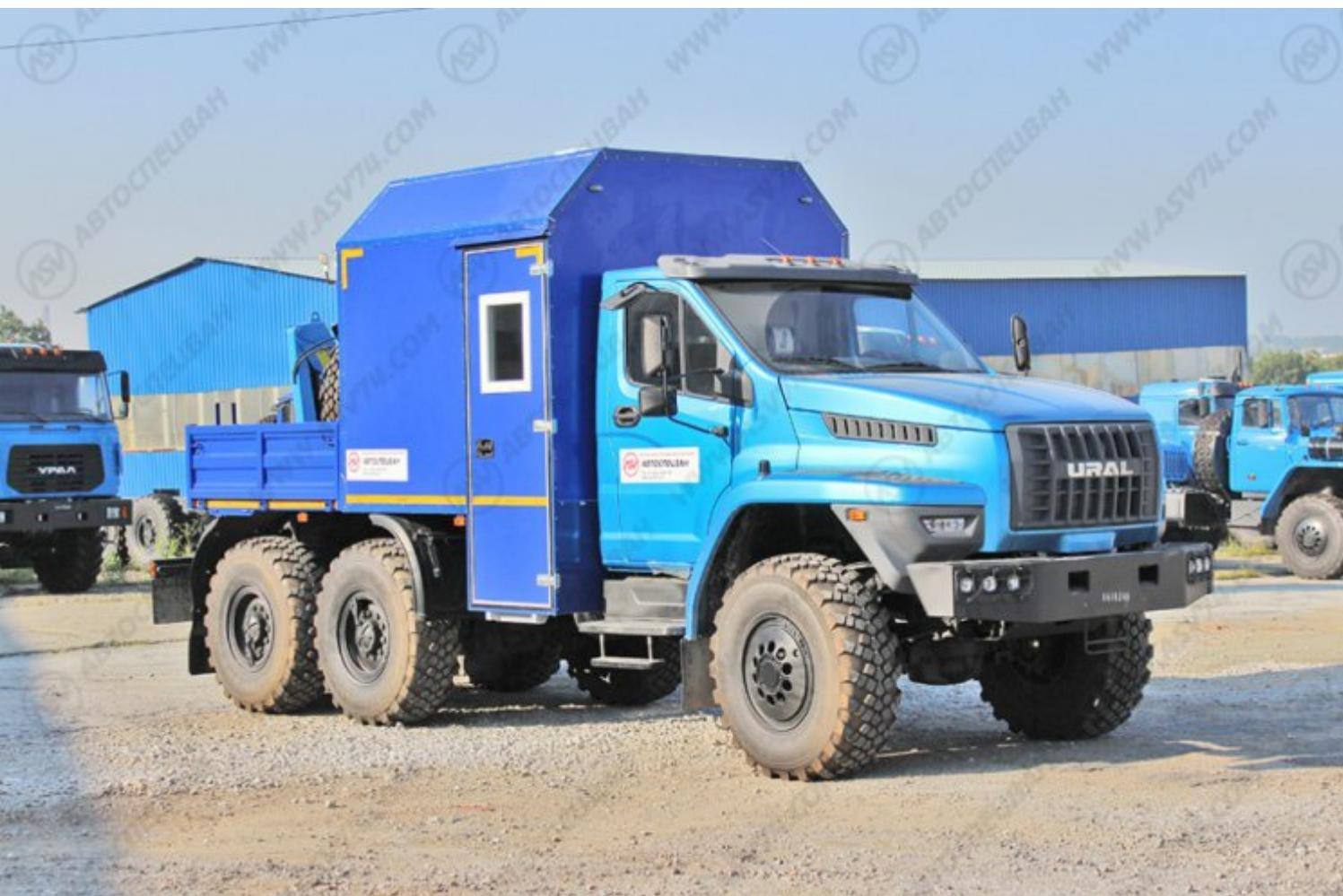
Грузопассажирский автомобиль (ГПА) - предназначен для транспортирования оборудования и перевозки экипажа в пассажирском отсеке, для выполнения комплекса работ по ремонту и техническому
