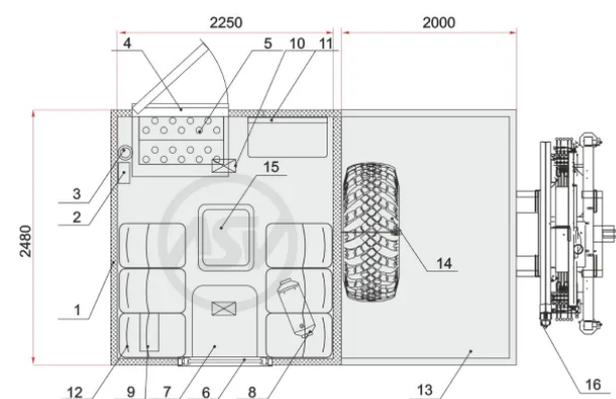
Кузов-фургон изотермический  $S=60$  мм ;
