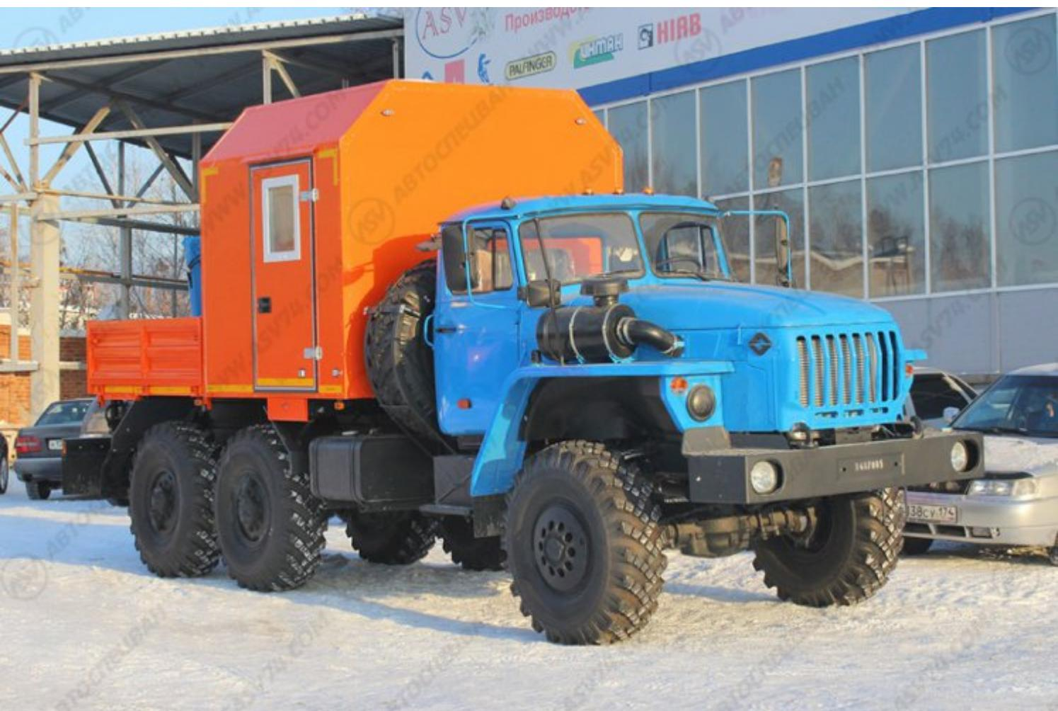
Грузопассажирский автомобиль (ГПА) - предназначен для транспортирования оборудования и перевозки экипажа в пассажирском отсеке, для выполнения комплекса работ по ремонту и техническому обслуживанию водопроводного и нефтепроводного оборудования
