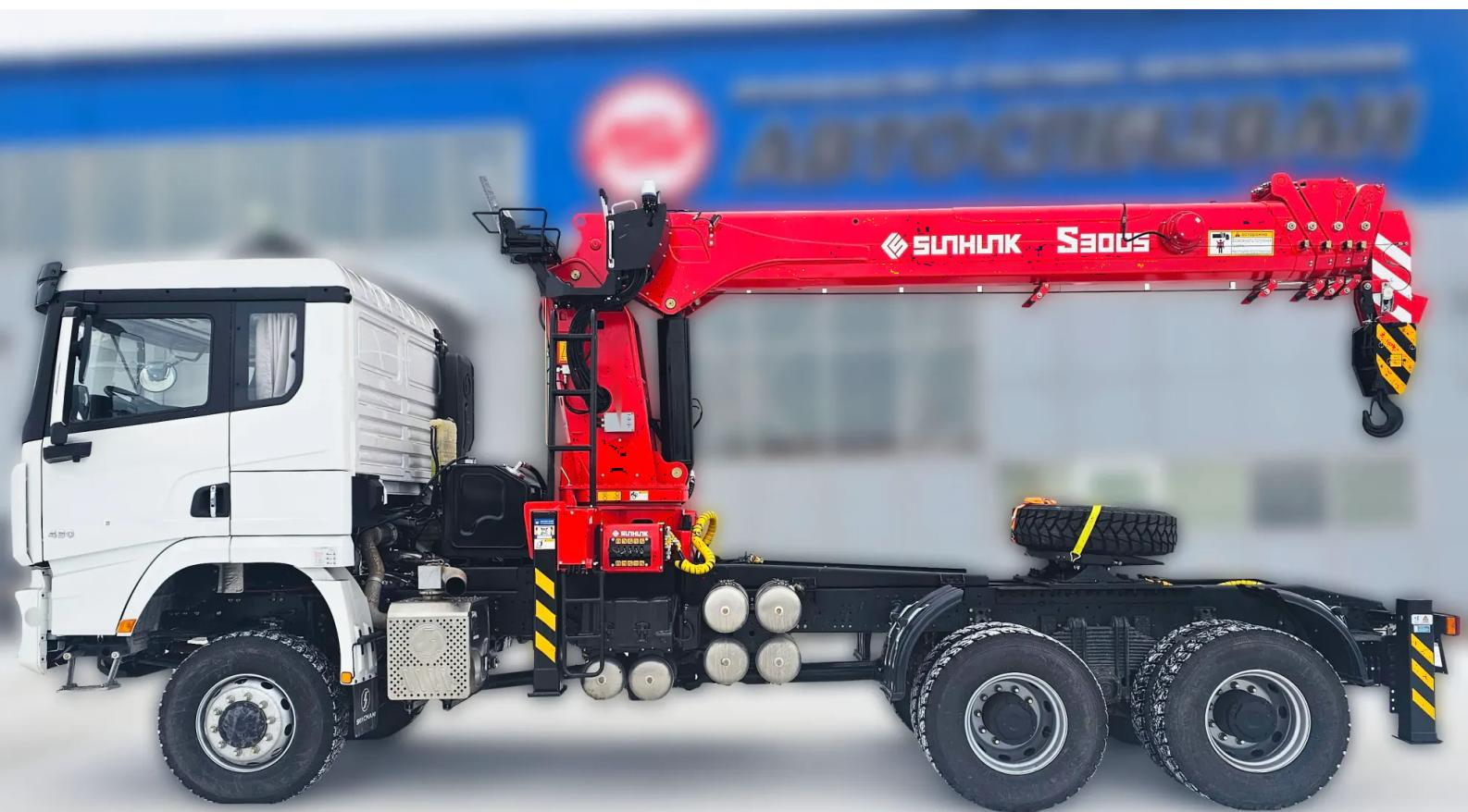
Кран-манипулятор модели Sunhunk S3005 применяется для осуществления различных погрузочно-разгрузочных работ и проведения строительно-монтажных мероприятий. Этот шарнирно-сочлененный манипулятор китайского производства имеет следующие технические характеристики: его грузоподъемность составляет 12 тонн при
