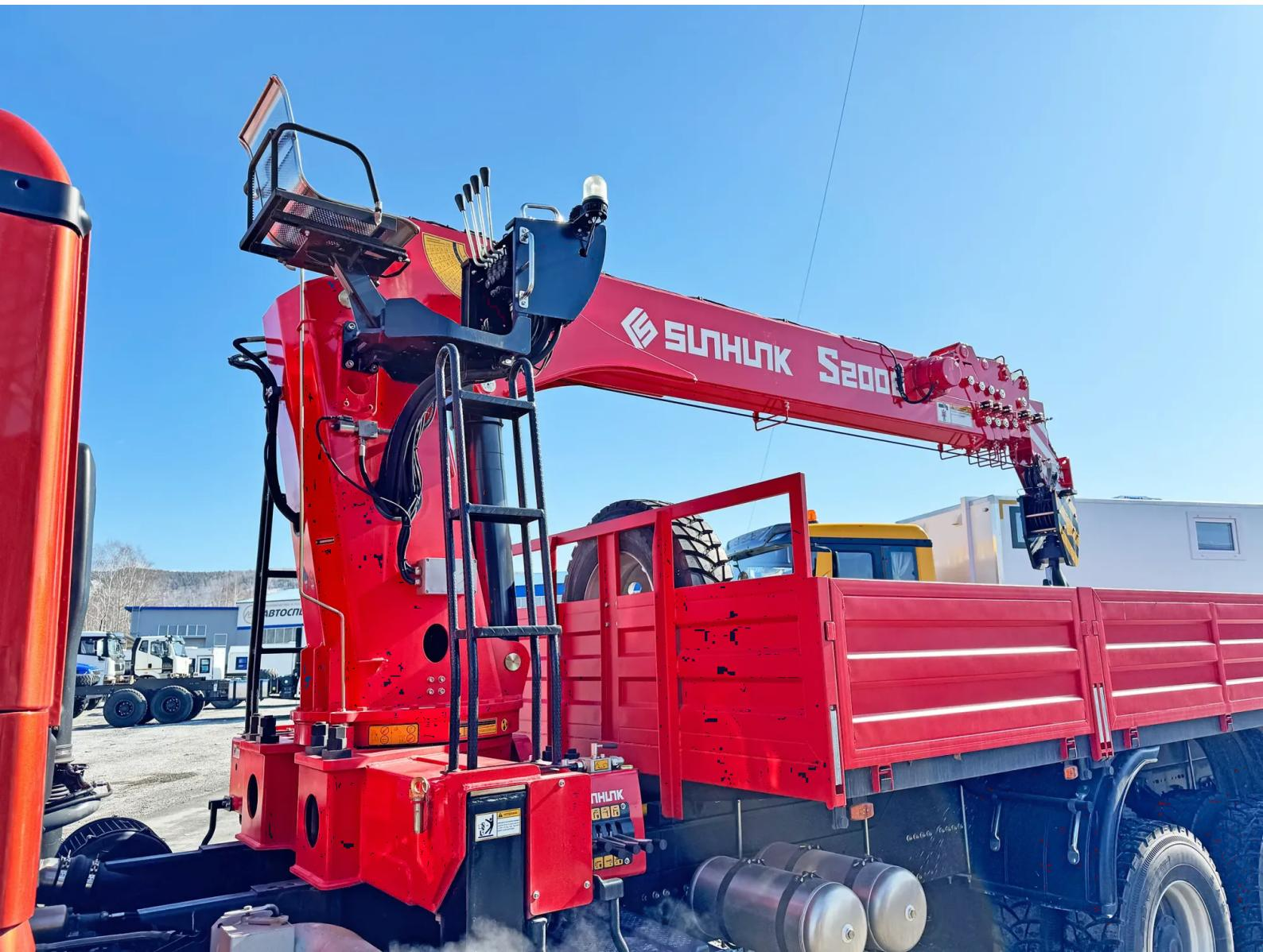
Кран-манипулятор модели Sunhunk S2006 используется для выполнения разнообразных погрузочно-разгрузочных операций и осуществления строительно-монтажных мероприятий. Эта конструкция шарнирно-
