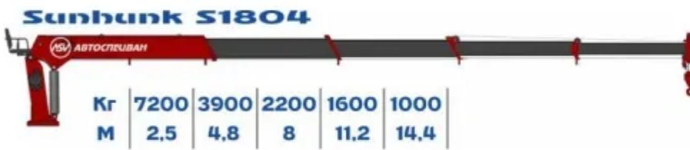
Кран-манипулятор Sunhunk S1804 используется для осуществления погрузочных и разгрузочных действий, а также проведения строительно-монтажных работ. Эта модель шарнирно-сочлененной конструкции, произведенная в Китае, обладает рядом следующих технических характеристик: грузоподъемность манипулятора составляет 10 тонн при минимальном вылете стрелы 2 метра и достигает 1,75 тонн при максимальном вылете в 12,54 метра.
