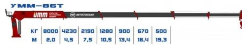
КМУ с тросовой подвеской крюка, максимальной грузоподъемностью 8 т. На сегодня это самая грузоподъемная крано-манипуляторная установка выпускаемая в России. Имеет максимальный вылет стрелы – 19,4 м и высоту подъема - 21,7 м. УММ 86Т имеет полноповоротную конструкцию, благодаря чему имеется возможность поворота стрелы на 360 градусов без ограничения числа оборотов.
