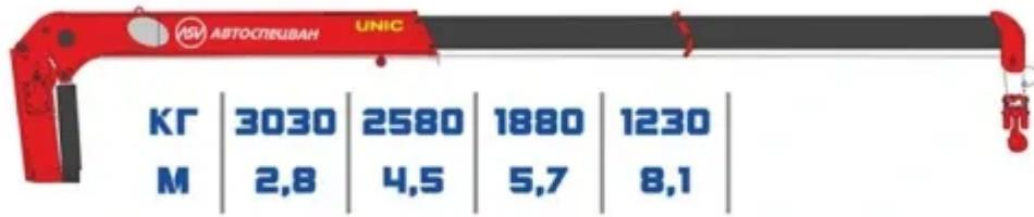
Крано-манипуляторная установка (КМУ) средней грузоподъемности UNIC UR-V503 (3-секционная стрела)
