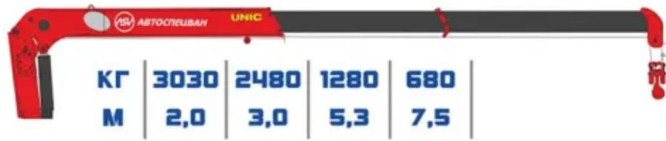
Крано-манипуляторная установка (КМУ) малой грузоподъемности UNIC UR-V373 (3-секционная стрела).
