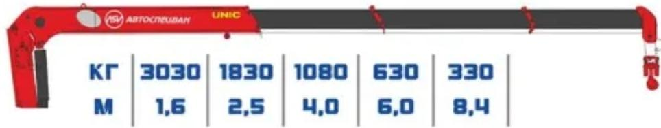
Крано-манипуляторная установка (КМУ) малой грузоподъемности UNIC UR-V294 (4-секционная стрела).
